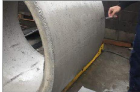
Precast concrete manhole module
